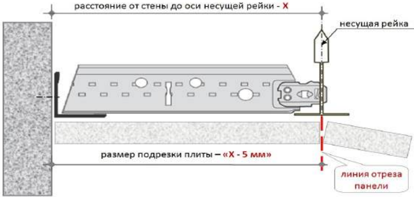
Рис. 50. Правильная обрезка панели
