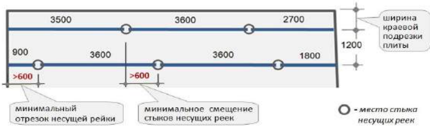
Рис. 24. Смещение стыков несущих реек, минимальный отрезок несущей рейки
